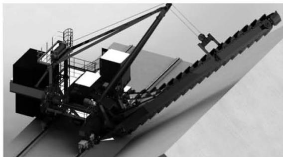
图2 多类型无挡墙取料机三维效果图
