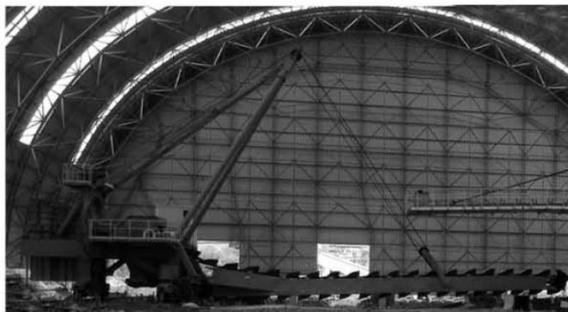
图3 多类型无挡墙取料机安装效果图
